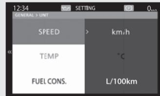
Dacă dorîți să selectați "L/100km" sau "km/L" pentru consumul de combustibil, trebuie, în prealabil să selectați "km/h" în meniu "SPEED".
