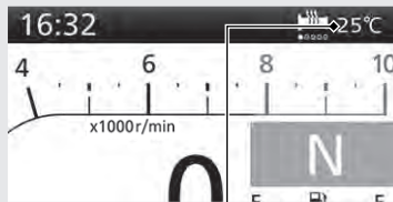
Indicator temperatură exterioară
